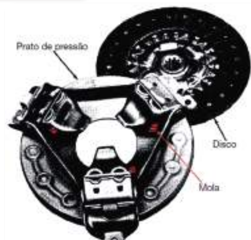
Figura 140 - Embraiagem de disco único e pormenor
