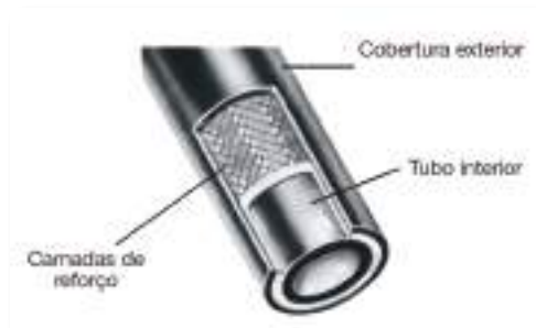
Figura 244 - Constituição de um tubo flexível
