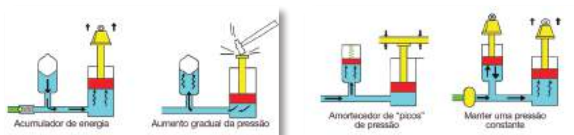
Figura 243 - Acumuladores hidráulicos
