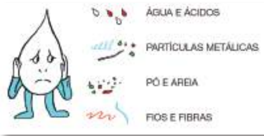
Figura 225-A - Contaminantes do óleo
